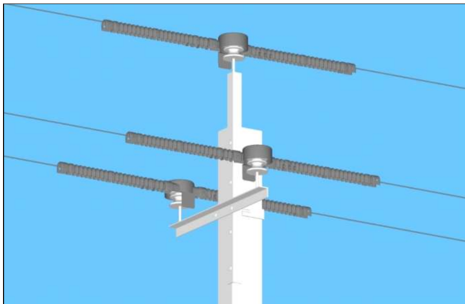
Рис. 21. Опора ВЛ, оборудованная ПЗУ -6-10кВ-МЛ-2-НГ
